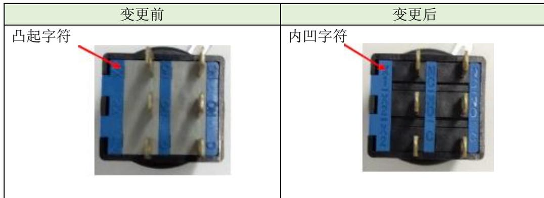
(ii) 触点块零件颜色
